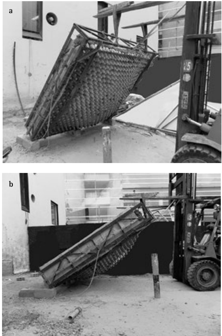
Figura 7: Ensayo preliminar de volteo en muros de botellas. a) Detalle del volteo con Montacargas. b) Estado del muro con una inclinación de 60 grados. Fotografía: Cecilia López Pérez
